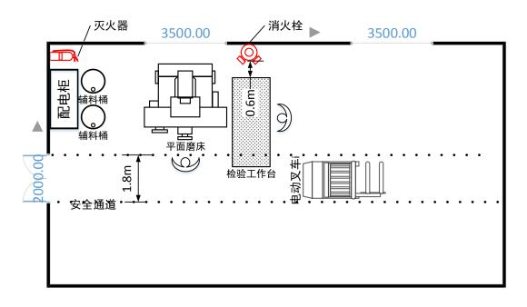
接受审核的某单位机械加工厂房局部工作场所示意图如上。请明确指出该工作场所存在的不符合项。
